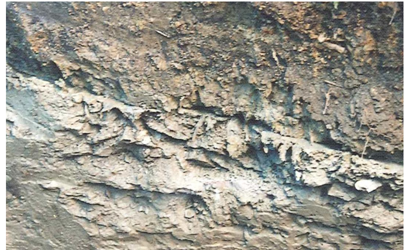
c) すべり面を形成する軟質粘土を挟在する層理面
