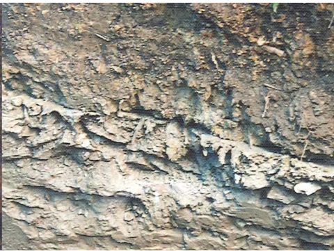
a)スラリー粘土付着 b)軟質粘土挟在 c)水膜面へばりつき d) 鏡 肌
