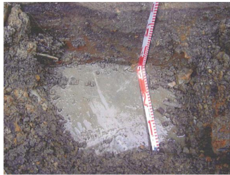
a)スラリー粘土付着 b)軟質粘土挟在 c)水膜面へばりつき d) 鏡 肌
