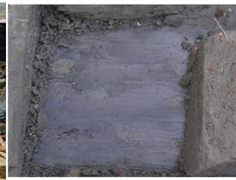
a)スラリー粘土付着 b)軟質粘土挟在 c)水膜面へばりつき d) 鏡 肌
