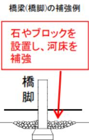
橋梁(橋脚)の補強例
