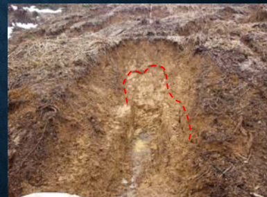
トレンチ掘削から1日が経過した4/26の状況。 斜面中に亀裂が認められる。
