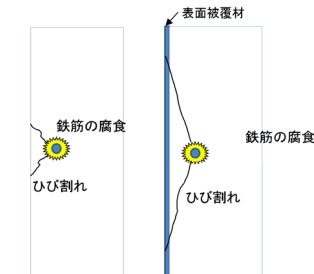
図 1-1 鉄筋腐食による表面被覆材の割れ
